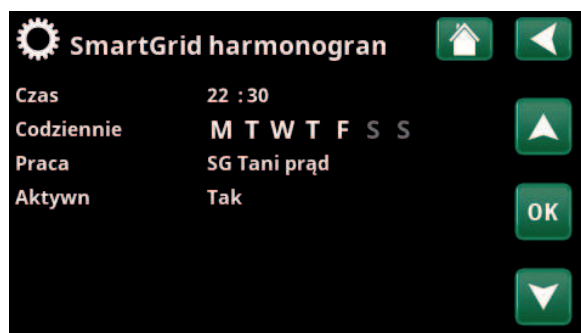
Działanie funkcji SmartGrid „SmartGrid Tani prąd” zaplanowano na dni w godzinach 22:30–06:00. Przejdź do menu, wybierając pozycję „SmartGrid harmonogramu” w menu „Instalator\Ustawienia”.
