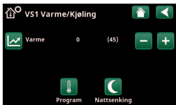
Menyen «Avansert/Definere/Varmesystem/Varmesystem 1». Varmesystemet har ikke romføler. Børverdien vises i parentes (turledningstemperatur 45^{\circ}\text{C} ). Til venstre for børverdien vises utetemperaturen ( 0^{\circ}\text{C} ) ved aktuell turledningstemperatur.
