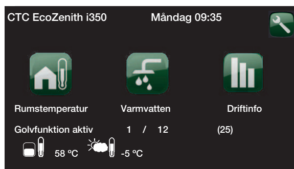
Eksempel for driftsinfo Mode 2, dag 1 av 12 med aktuell børverdi (25) °C.
