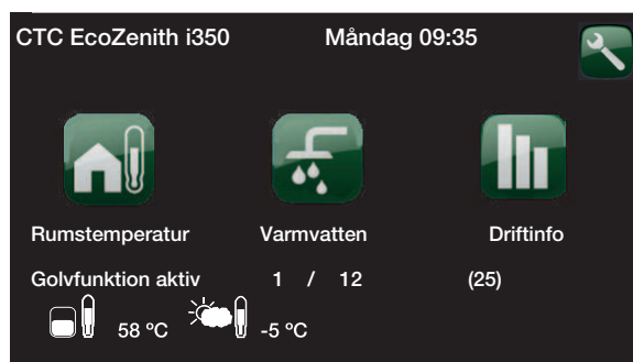
Eksempel på driftsdata ved Driftsform 2, Dag 1 af 12 med en aktuell indstillingsværdi (setpunkt) på 25°C.
