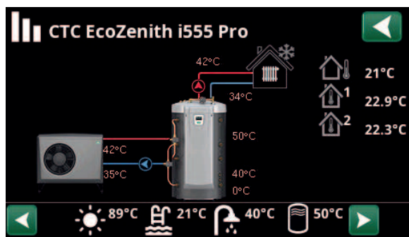
Huvudmenysidan för "Driftinfo" med luft/vatten värmepump CTC EcoAir ansluten.
