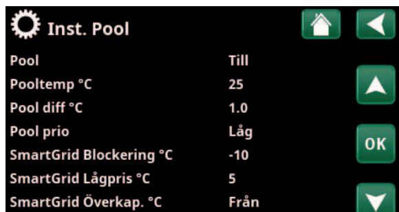
Meny "Avancerat/Inställningar/Pool". Pooltemperaturen höjs med 5 °C när funktionen "SmartGrid Lågpris" aktiveras.
