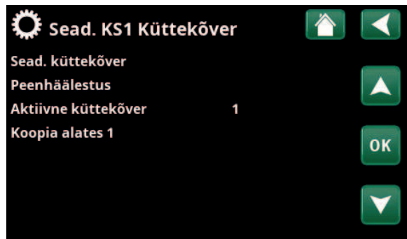
Menüü „Paigaldaja/Seadistus/Küttering/Küttering 1/Kütteköver“.
