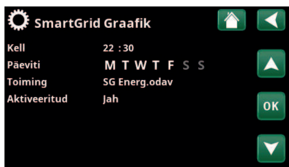
SmartGrid funktsioon „SG Odav energia” on ajastatud tööpäevadeks kell 22.30–06.00. Valige menüüs „Paigaldaja/Seadistus” valik „SmartGrid graafik”.
