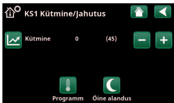
Menüü „Paigaldaja/Määratlemine/Küttering/Küttering 1“. Kütteringil ei ole ruumiandurit, seadeväärtus on näidatud sulgudes (esmane voolutemperatuur 45\text{ }^{\circ}\text{C} ). Seadeväärtusest vasakul on välistemperatuur ( 0\text{ }^{\circ}\text{C} ) praegusel pealevoolu temperatuuril.
