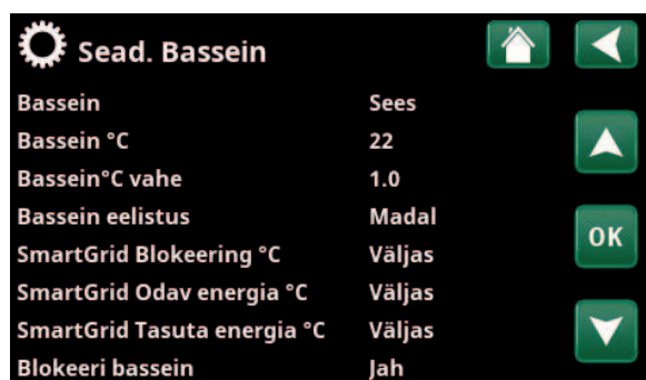
Menüü: „Paigaldaja/Seadistus/Bassein“. SmartGrid odava energia funktsiooni aktiveerimisel tõstetakse basseini temperatuuri 1 °C.
