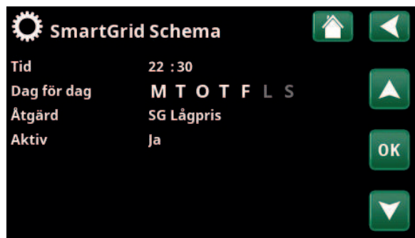
Meny "Avancerat/Inställningar/SmartGrid Schema".
