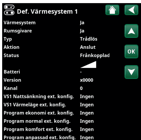
Meny "Avancerat/Definiera/Värmesystem/Värmesystem 1". Trådlös rumsgivare har valts.
