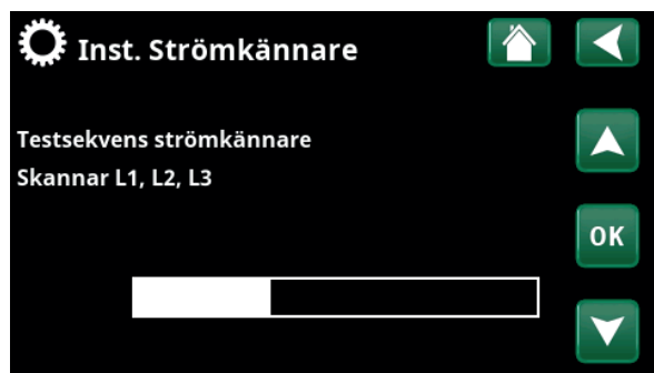
Meny "Avancerat/Inställningar/Strömkännare/Automatkonfig. strömkännare".
