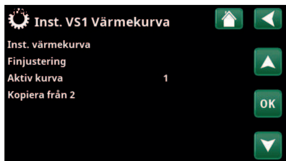
Meny "Avancerat/Inställningar/Värmesystem/ Värmesystem 1/Värmekurva". Aktiv kurva: #1.
