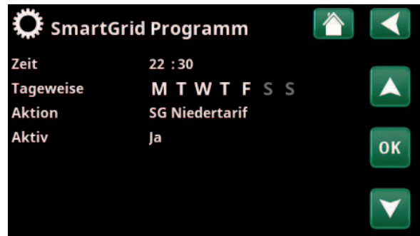
Die Funktion SmartGrid „SG Niedertarif“ ist für Wochentage zwischen 22:30 und 06:00 vorgesehen. Das Menü erscheint, wenn Sie im Menü „Fachmann/Einstellungen“ das „SmartGrid Wochenprogramm“ anwählen.
