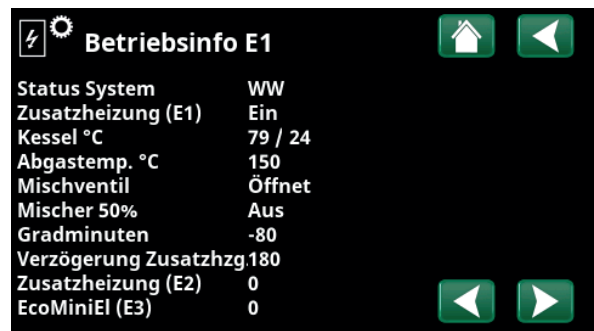
Menü „Betriebsinfo E1“ Klicken Sie auf die Pfeile oder wischen Sie im Menü, um die definierten zusätzlichen Wärmequellen anzuzeigen.
