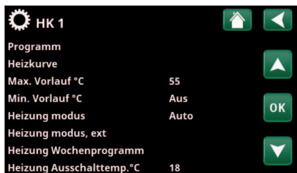
Menü: „Fachmann/Einstellungen/Heizkreis“ In der Menüleiste „Heizung Modus, ext“ wird die Fernsteuerung für den Heizkreis festgelegt. Zugriff auf das Wochenprogramm erhalten Sie über die Menüleiste „Heizung Wochenprogramm“.
