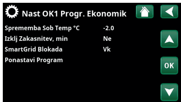
Meni: »Instalater/Nastavitve/Ogrevalni krog/Ogrevalni 1/Program/Ekonomik«.
