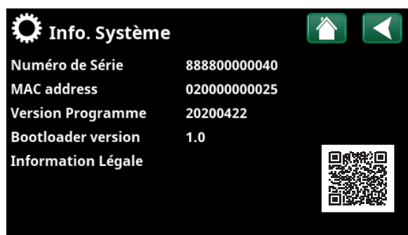
Menu : «Installeur/Info. Système» Pour accéder à ce menu, cliquez sur le bouton «i» en bas à droite de l'écran du menu «Installeur».
