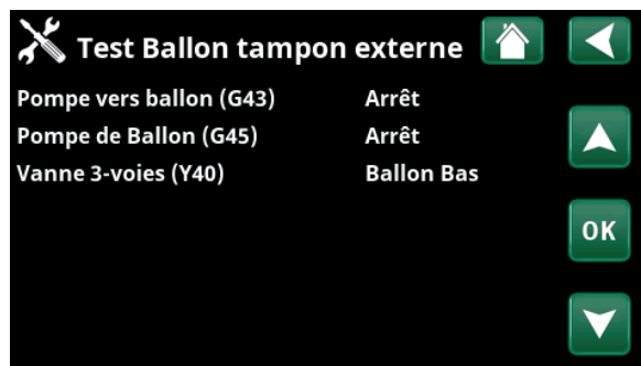
Menu : «Installateur/Service/Test Relais/Ballon tampon externe».
