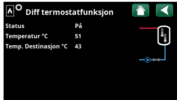
Meny «Driftsinfo/Diff termostatfunksjon».
