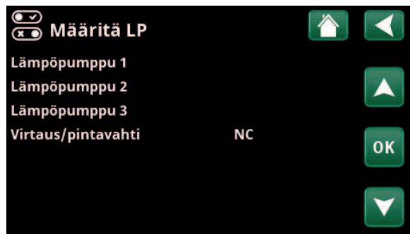
Esimerkki järjestelmästä, jossa kolme lämpöpumppua. Valikko "Lisäasetukset/Määritä järjestelmä/Lämpöpumppu"
