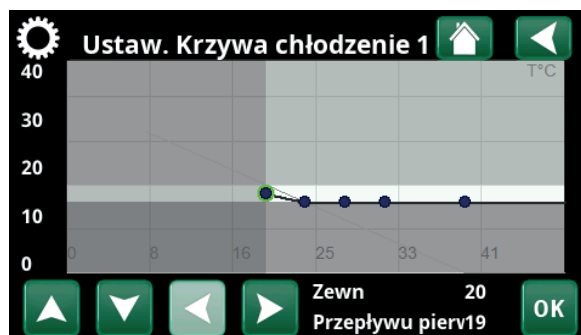
Menu „Instalator\Ustawienia\Chłodzenie\Krzywa chłodzenie/Optymalne ustawienie”.
