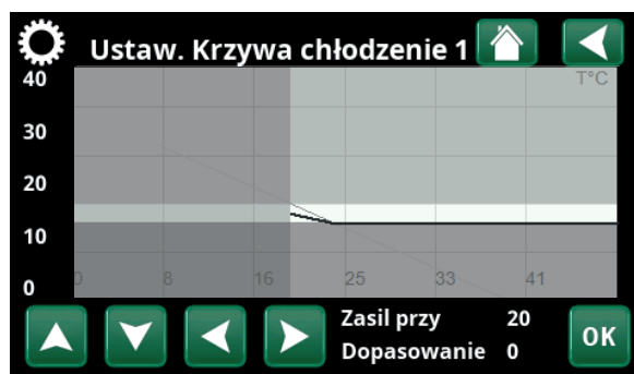
Menu „Instalator\Ustawienia\Chłodzenie\Krzywa chłodzenie/Ustaw. Krzywa chłodzenie”.
