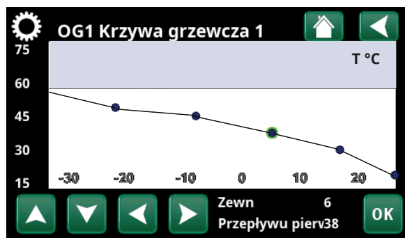
Menu „Instalator\Ustawienia\Obieg grzewczy\Obieg grzewczy 1/Krzywa grzewcza/Optymalne ustawienie”.
